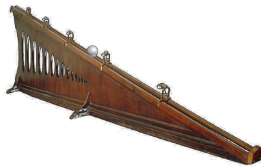
Figura 5.1: Plano inclinado de Galileo.
